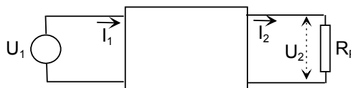
Slika 3.3. Četvorokrajno elektronsko kolo
