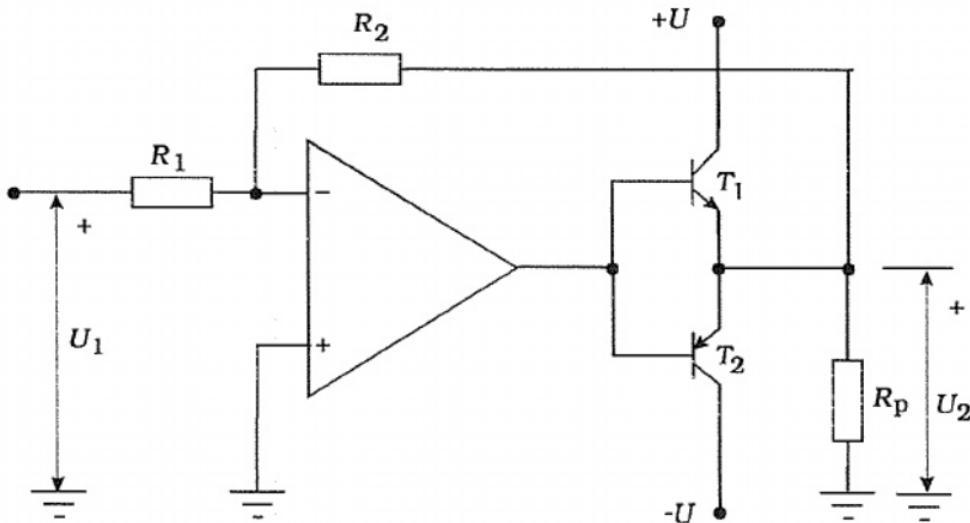
Tranzistori  $T_1$  i  $T_2$  takođe služe kao strujni pojačavači, a potrošač je stavljen u njihovo emitorsko kolo. Ukoliko je izlazni napon pozitivan struja teče od  $+U$  kroz  $T_1$ , potrošač  $R_p$  ka masi. Pri negativnom izlaznom naponu struja teče od mase kroz potrošač  $R_p$ ,  $T_2$  ka  $-U$ .
