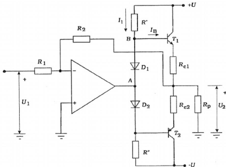
Diode D<sub>1</sub> i D<sub>2</sub> služe za kompenzaciju praga provođenja tranzistora T<sub>1</sub> i T<sub>2</sub>. Ako je izlazni napon jednak nuli, tada struja teče od +U kroz R', D<sub>1</sub>, D<sub>2</sub> i R" ka -U. Na diodama D<sub>1</sub> i D<sub>2</sub> formira se napon koji je približan pragu provođenja tranzistora T<sub>1</sub> i T<sub>2</sub>.
