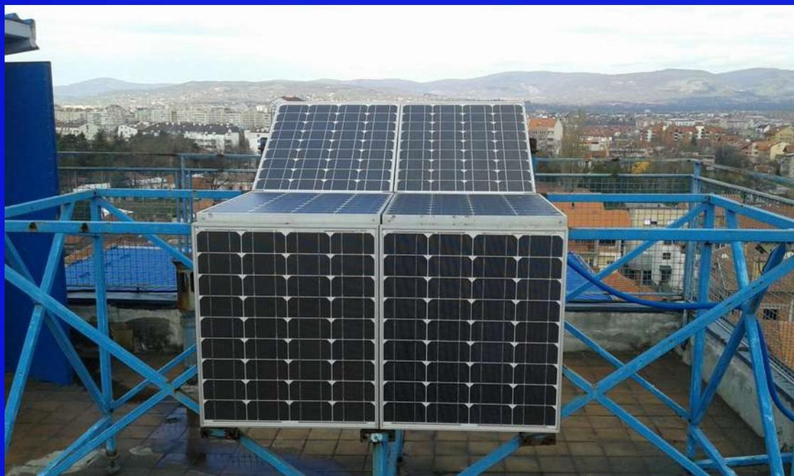
**Sistem solarnih modula ISF-60/12 od monokristalnog silicijuma, za ispitivanje uticaja zaprljanosti solarnih modula na njihovu efikasnost**
