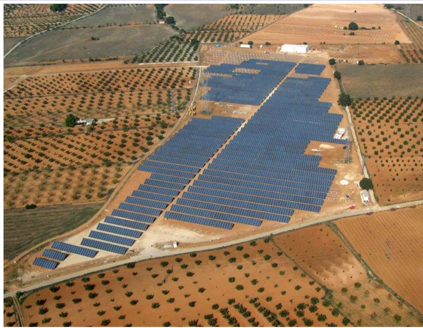
**Solarna elektrana u Španiji, snage 20 MW, zauzima površinu od 500 000 m<sup>2</sup> i godišnje proizvodi 30 GWh električne energije**
