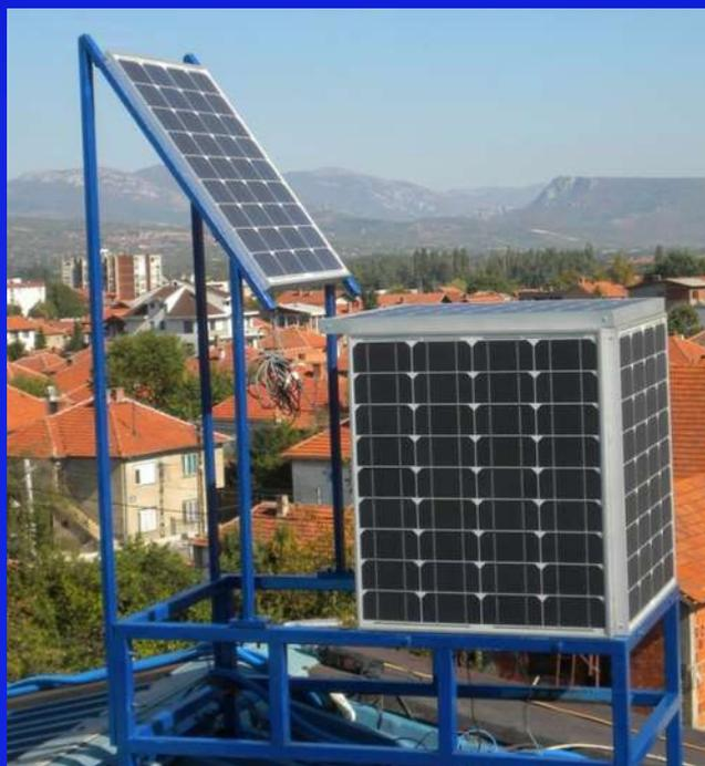
**Solarni sistem za određivanje energetske efikasnosti solarnih modula u zavisnosti od njihove geografske orijentacije i ugla nagiba**
